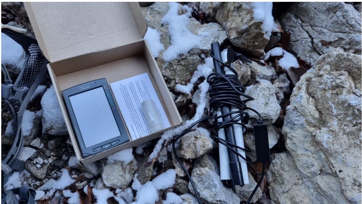
slika 4: Vmesnik Vernier Labquest in merilec pretoka
