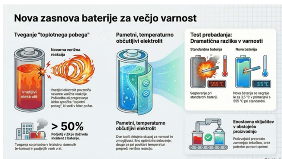
Slika 14: Prikaz termičnega pobega baterije (vir: https://sustainability.unesco-floods.eu/2025/12/22/raziskovalci-trdijo-da-bi-majhna-sprememba-v-zasnovi-baterije-lahko-zmanjsala-stevilo-pozarov-cnn-science-22-december-2025/ )
