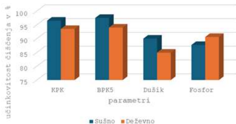
Slika 9: Učinkovitost čiščenja posameznih parametrov v deževnem in sušnem obdobju
