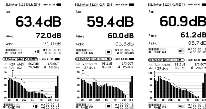
Slika 16: Rezultati meritev z zvokomerom na merilnem mestu na Školjčiču (levo), na Moletu (sredina) in na Ukmarjevem trgu (desno)
