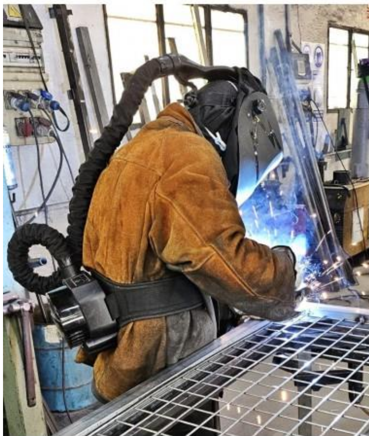
Slika 4: Primer uporabe nadtladne zaščitne maske varilca med postopkom varjenja (Vir: Medmrežje 7)
