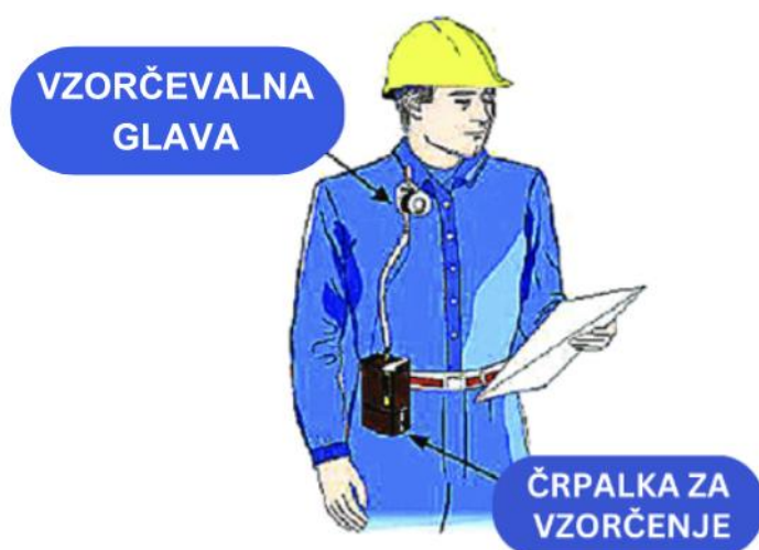
Slika 5: Merilna naprava za osebno vzorčenje (Prirejeno po: Medmrežje 8)
