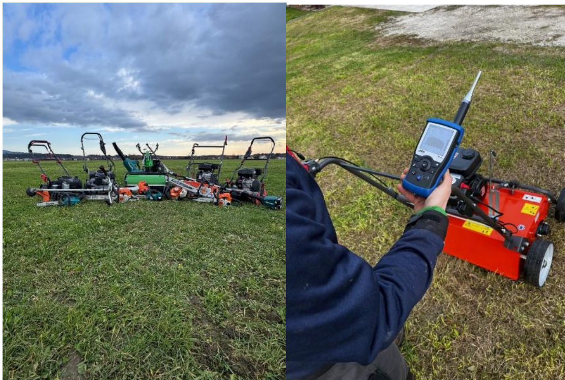
Slika 1: Na sliki je prikaz merjenja hrupa vrtnih orodij: Levo. Nabor vrtnih strojev, ki jih uporabljam pri svojem delu. Desno: prve meritve (Vir: Alen Lamper, 26. nov. 2024)
