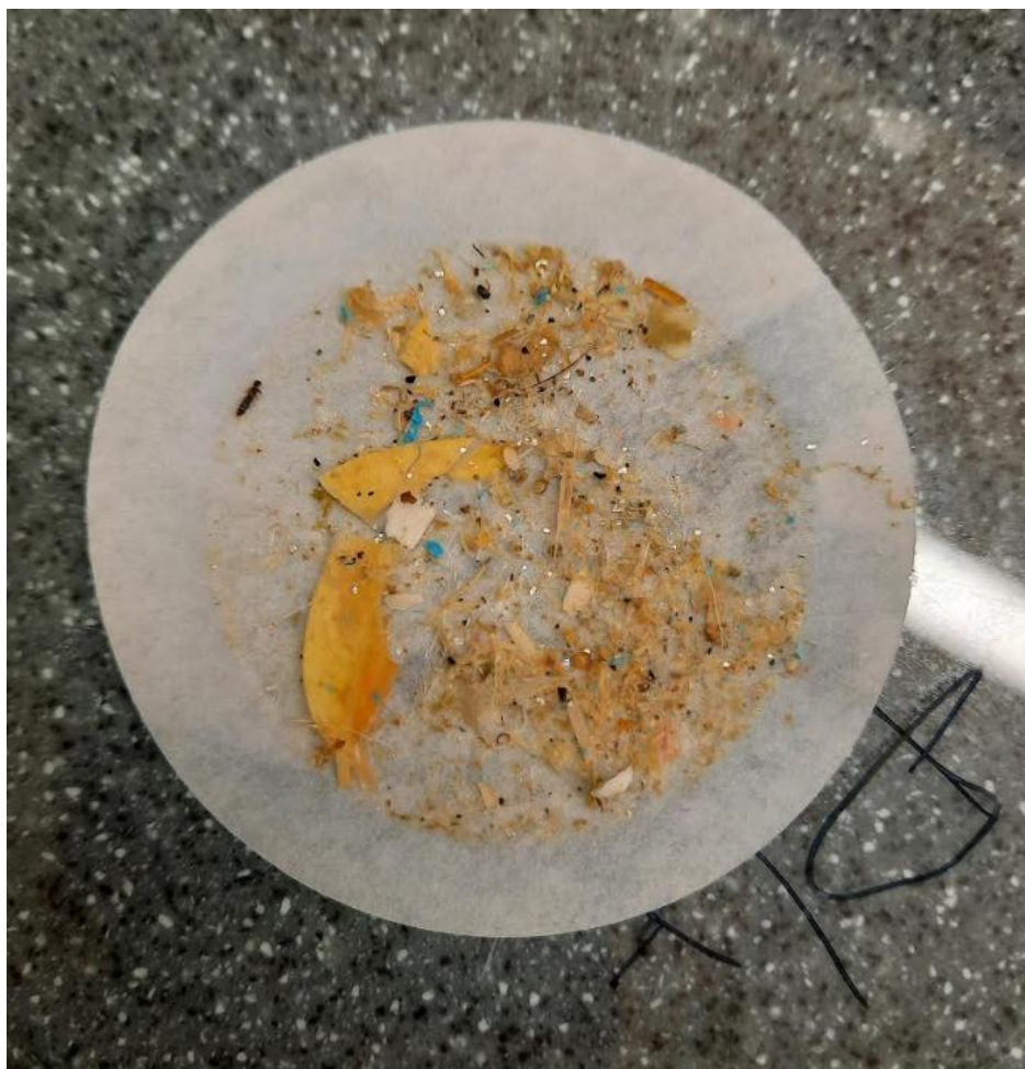
Slika 17: Kontaminiran vzorec z modrimi PP delci na filter papirju (Vir: lasten)
