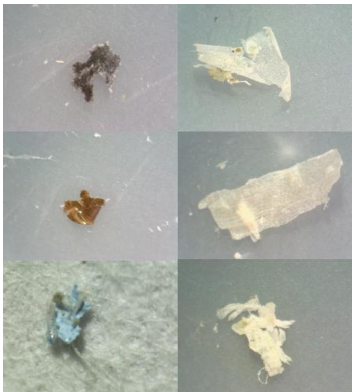
Slika 19: Različni mikroplastični delci pod stereo mikroskopom (Vir: lasten)
