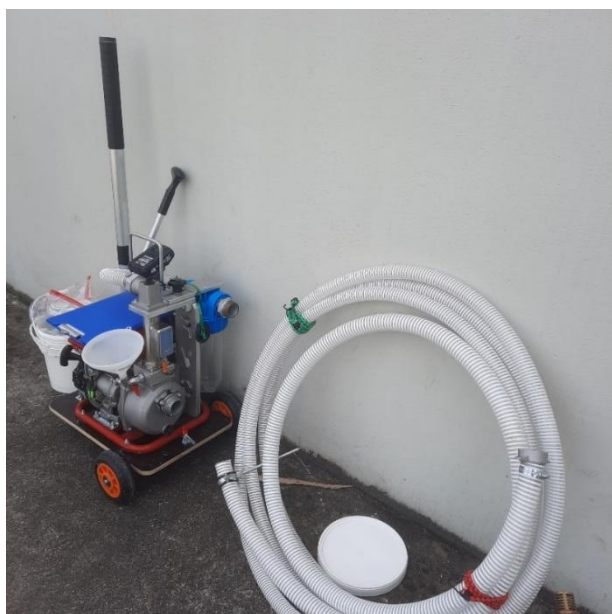
Slika 8: Vzorčevalnik FVO z vozičkom ter vtočnimi in iztočnimi cevmi (Vir: lasten)
