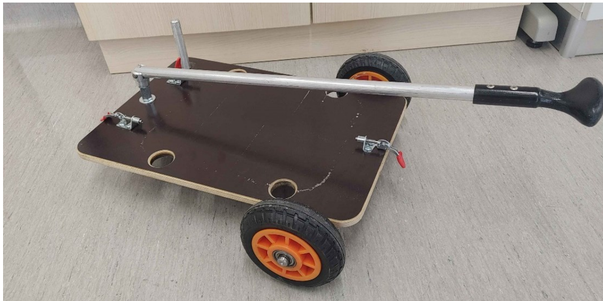
Slika 21: Voziček za prevoz črpalke z zaklopkami za pritrditev črpalke.
