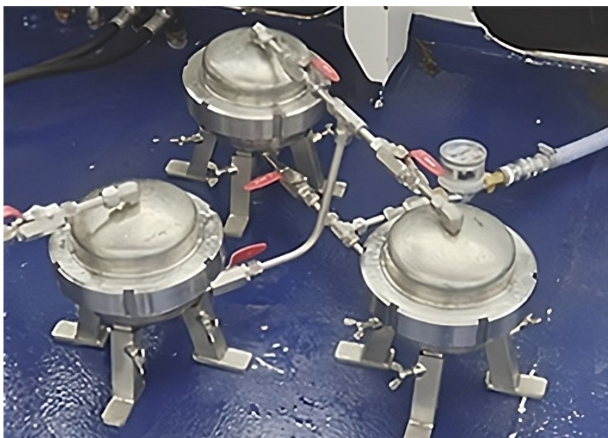
Slika 4: UFO" filtrirna naprava za vzorčenje mikroplastike (vir: Rist et al., 2020)
