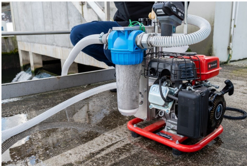
Slika 19: Prototip za vzorčenje mikroplastike med obratovanjem na Centralni čistilni napravi Šaleške doline, 26. 1. 2024
