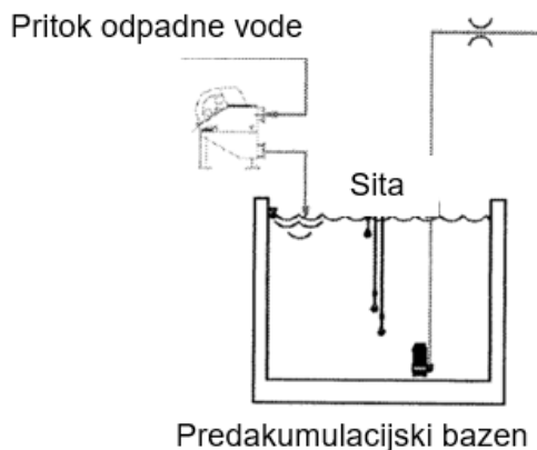
Slika 2: Izločitev delcev s siti in predakumulacijski bazen (Vir: Posredovalo izbrano podjetje, 2025)
