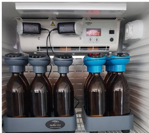
Slika 13: Inkubacijske steklenice v termostatski omari na magnetnem stojalu (Vir: foto. J. Pivk, 2025)
