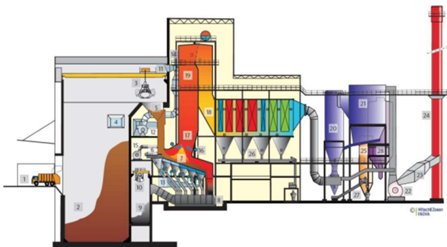
Slika 4: Shematični prikaz sežiganja odpadkov v sežigalnici. [4]
