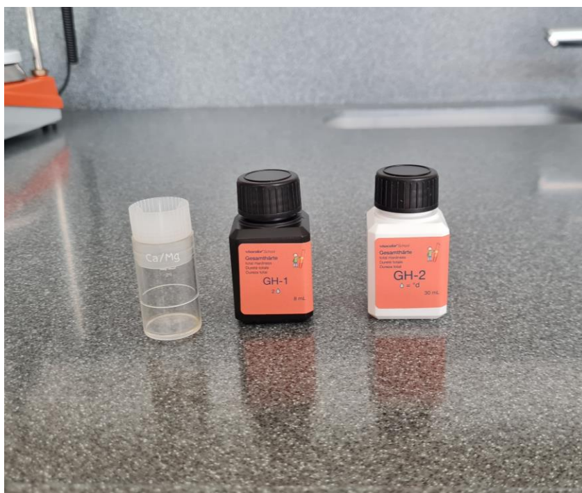
Slika 8: Hitri terenski kolorimetrični test EcoLabBox. (Vir: Aleksandra Lubej, 2023)
