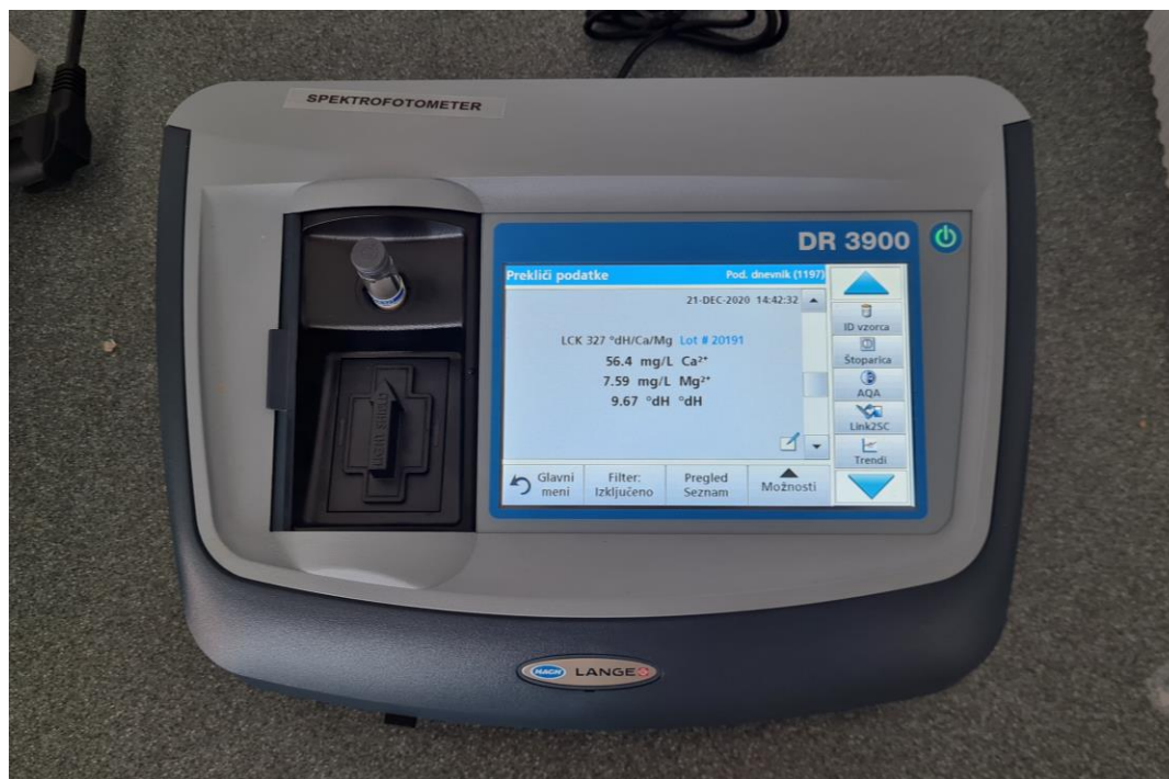
Slika 10: Spektrofotometer Hach Lange DR/3900 in shranjen zapis meritve s testom LCK 327. (Lasten vir, 2023)
