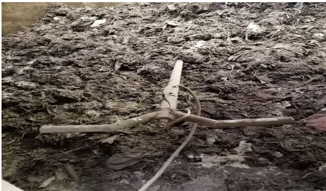
Slika 10: Sonda za merjenje temperature v kompostu.
