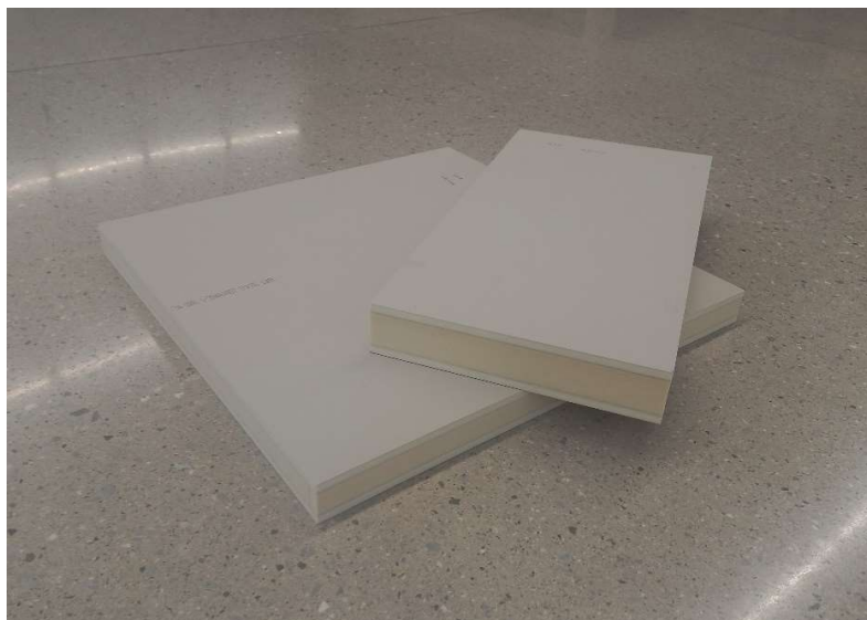
Slika 5: Integrirani VIP v konstrukcijsko ploščo (foto: Kristovič, 2023)
