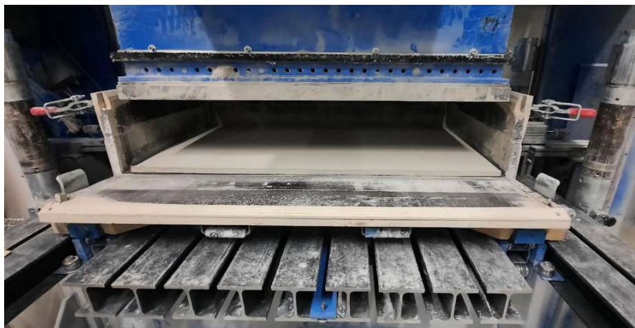
Slika 10: Iztisnjena plata po fazi mešanja surovin (foto: Kristovič, 2021)
