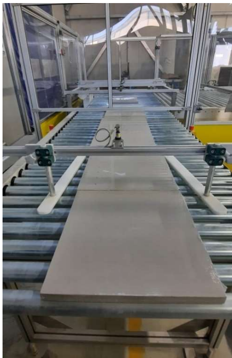
Slika 11: Ovito jedro, ki nadaljuje nadaljnji proces izdelave panela na avtomatski liniji (foto: Kristovič, 2021)
