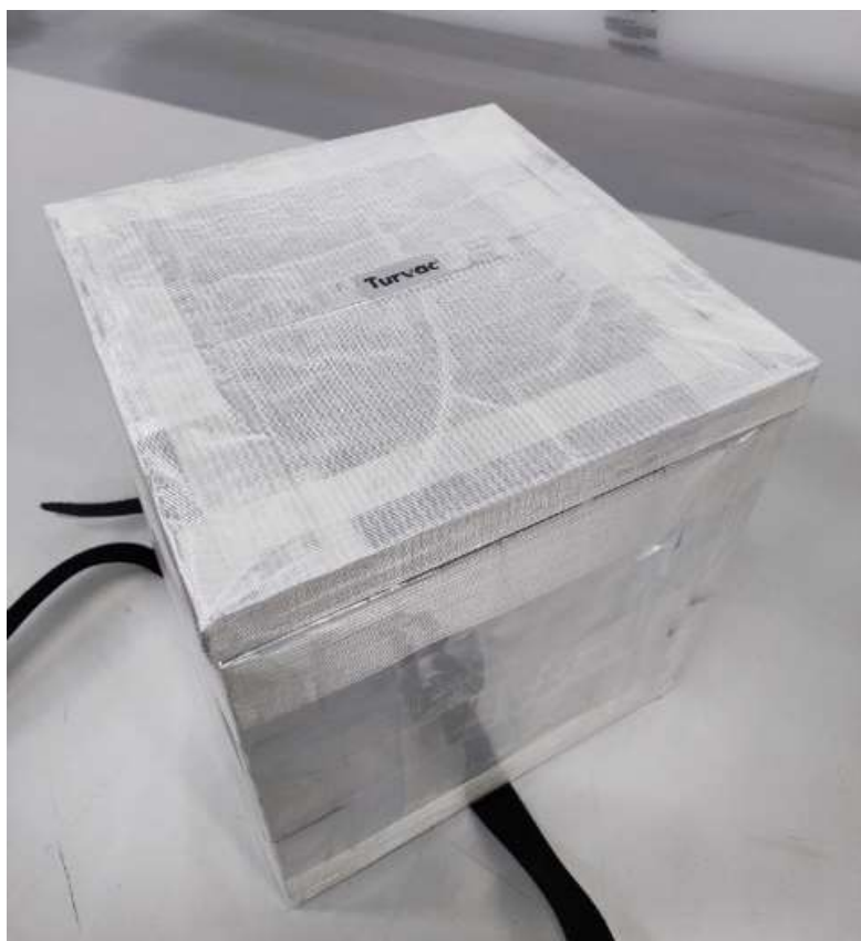
Slika 7: Škatla, izdelana iz vakuumskih panelov in drugih komponent (foto: Kristovič, 2023)
