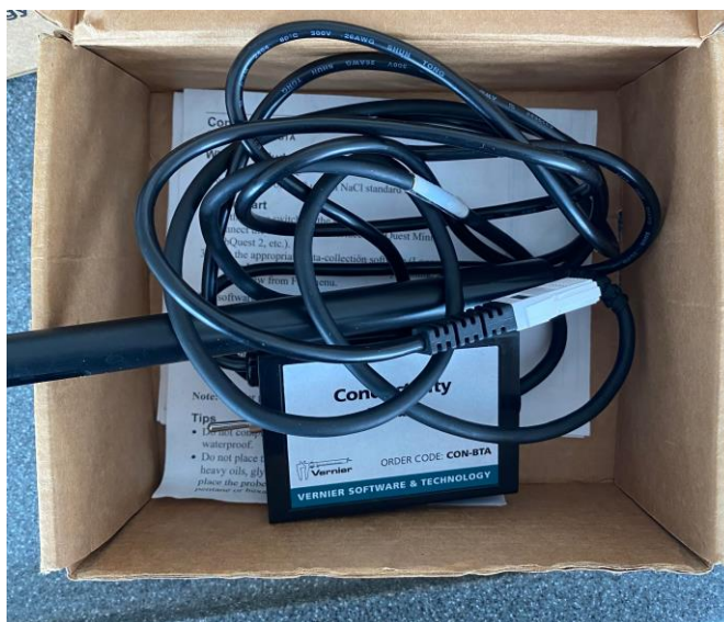
Slika 11: Senzor za merjenje električne prevodnosti vode (vir: lasten)
