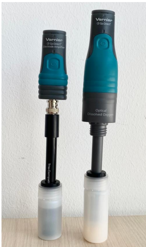
Slika 10: Senzor za merjenje raztopljenega kisika DO (desno) in senzor za merjenje pH vrednosti (levo) (vir: lasten)
