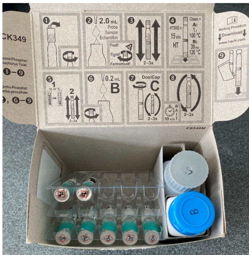
Slika 14: Kivetni test za fosfate LCK349 v vodnem vzorcu (vir: lasten)
