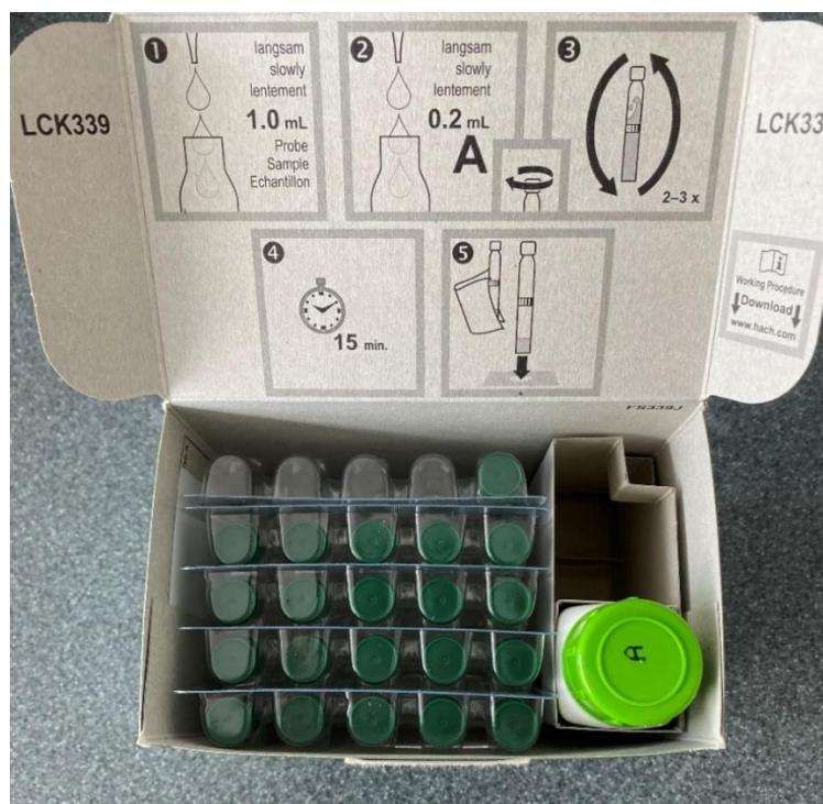
Slika 13: Kivetni test za nitrate LCK339 v vodnem vzorcu (vir: lasten)
