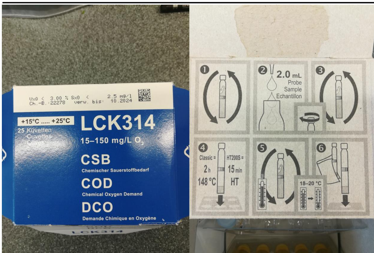
Slika 17: Navodila za merjenje kemijske potrebe po kisiku (Foto: M. Zabret, 2023)
