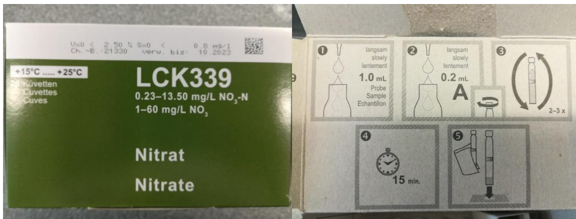
Slika 15: Navodila za merjenje vsebnosti nitratov (Foto: M. Zabret, 2023)
