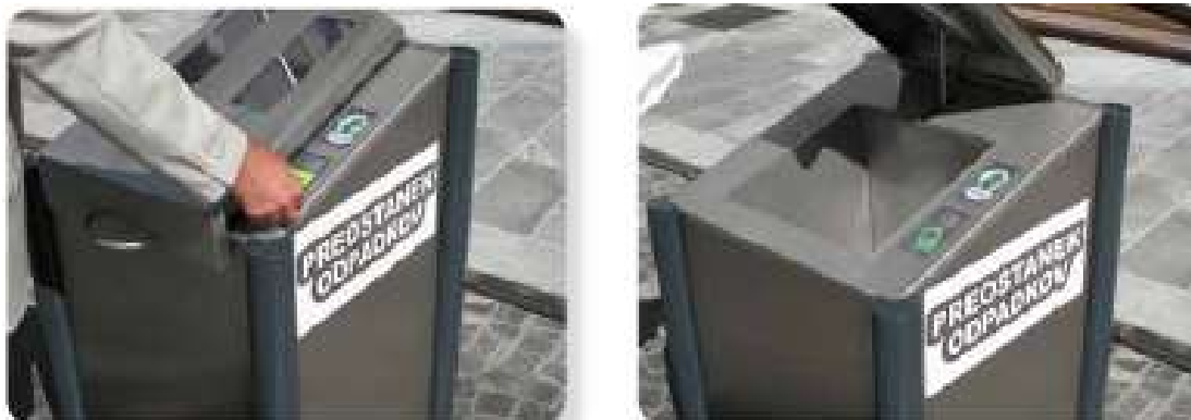
Slika 13: Na zaboyniku je čitalec kartice, ki jo prislonimo, ko želimo odvreči odpadke (Vir: Vokasnaga, 2019).
