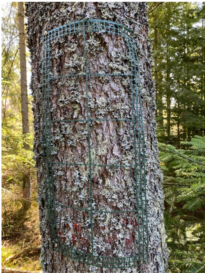
Slika 14: Vzorčevalna mrežica za popis po VDI metodi (foto: T. Sterže, 2022).
