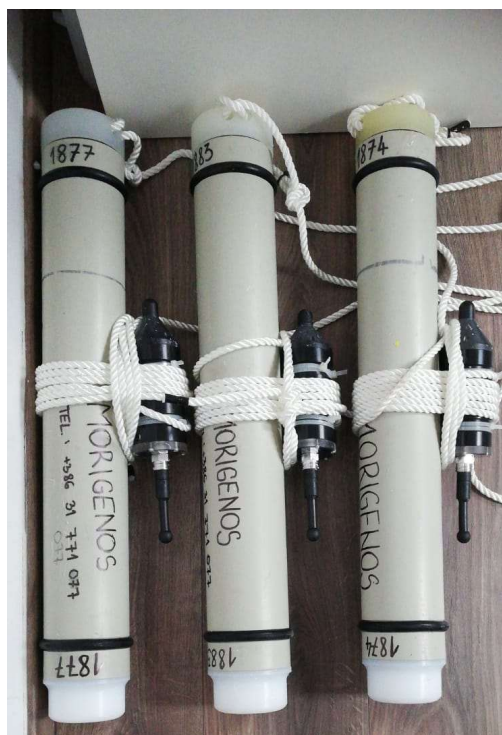
Slika 5: Priprava pasivnih akustičnih naprav C-POD (velike sive naprave) in SoundTrap (manjše črne naprave) za transport in potopitev. Vrvi ob napravi na sliki so tesno nameščene zgolj zaradi lažjega transporta do lokacije postavitve.
