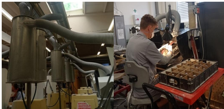
Slika 5: Odsesovalnik prahu (levo) in delavec pri glajenju stekla (desno), foto: I. Drozg, 2022
