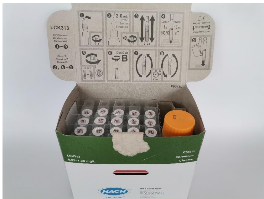
Slika 10: Kivetni testi merjenja kroma v vodnih vzorcih - LCK313 (vir: lasten)
