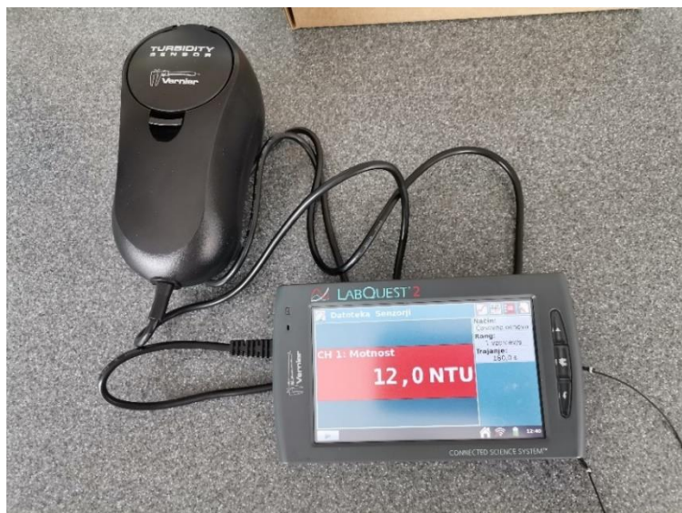
Slika 8: Merjenje motnosti vode (vir: lasten)
