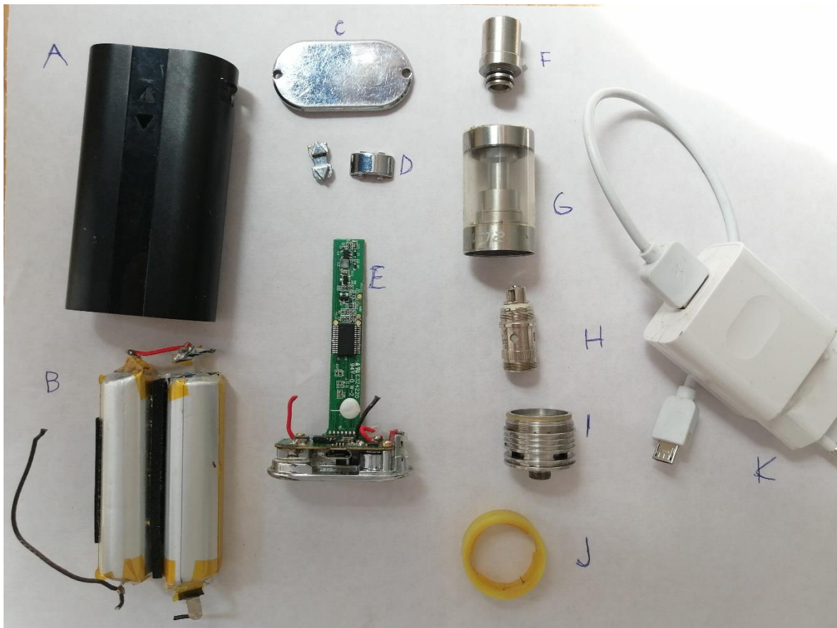
Slika 9: Razstavljena EC tretje generacije; ohišje in gumbi, baterija in vezje, rezervoar in polnilec
