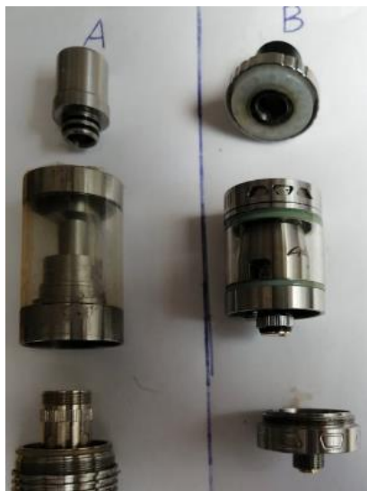
Slika 7: Dva različna rezervoarja s privitimi GG na spoj (A) in v rezervoar (B)
