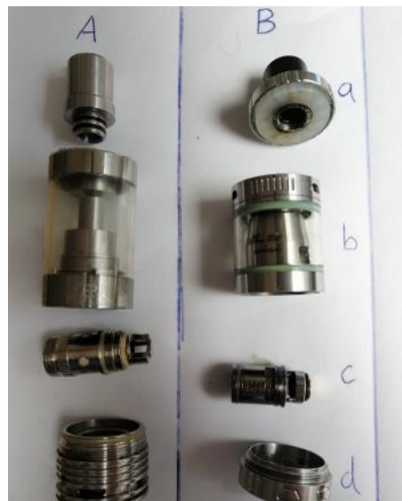
Slika 6: Dva različna modela rezervoarjev, ločena na ustnik, rezervoar, grelno glavo in spoj
