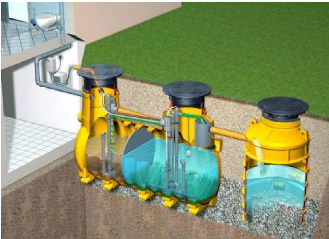
Slika 3: Biološka čistilna naprava (Vir: www.cistilinenaprave.si )
