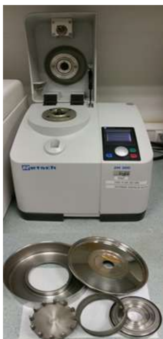
Slika 19: Ultracentrifugalni mlin ZM 200 in sestavni deli mlevnih orodij.
