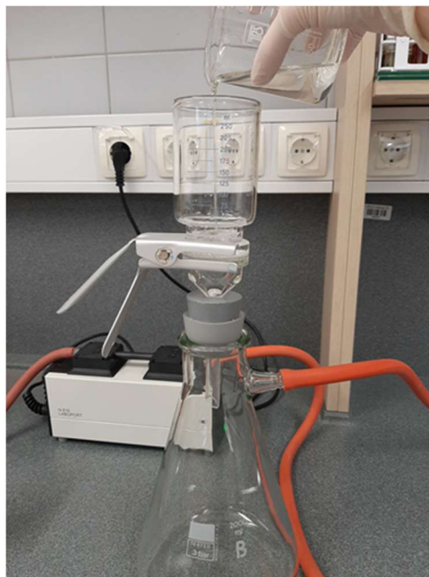
Slika 15: Vakuumska filtracija oksidirane raztopine vzorca naravnega medu (Foto: K. Hohkraut, 2024)
