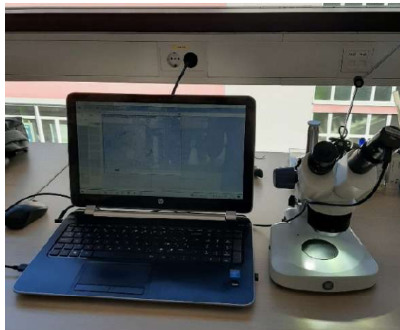
Slika 11: Pregled filtrov s stereolupo in DinoCapture programom (Foto: K. Hohkraut, 2024)
