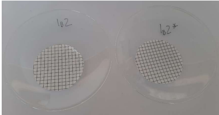
Slika 10: Sušenje filtrov vzorcev Ci2 in Ci2A na sobni temperaturi (Foto: K. Hohkraut, 2024)
