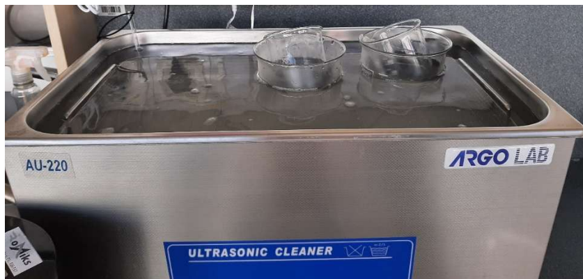
Slika 4: Ultrazvočno izpostavljanje filtrov v etanolu (Foto: K. Hohkraut, 2024)
