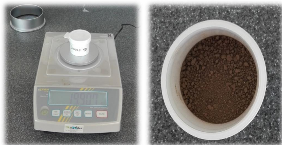
Slika 11: Tehtanje in končno pripravljen vzorec za nadaljnje analize
