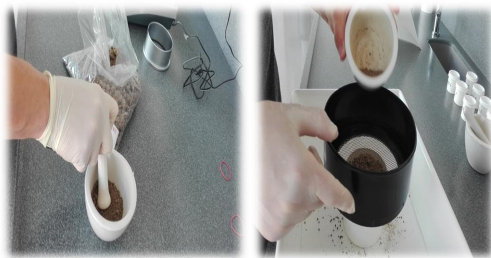
Slika 10: Upraševanje in presajanje vzorca
