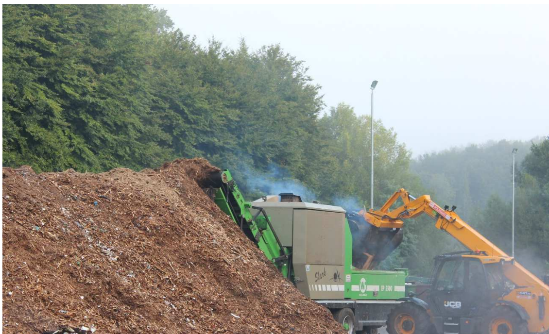
Slika 14: Mletje lesa – nastane strukturni material.
