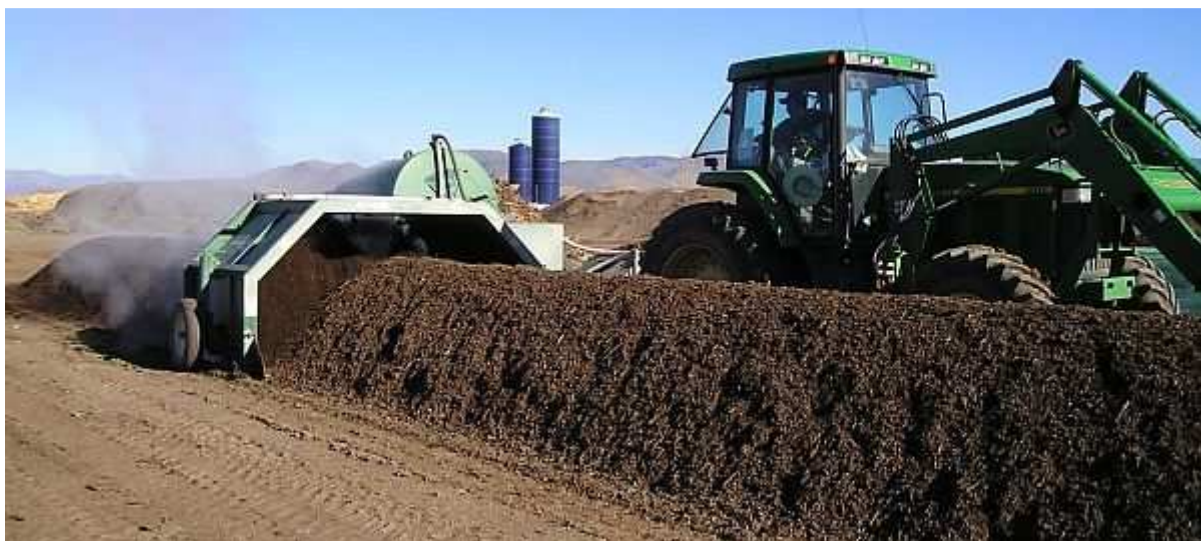
Slika 5: Kompostiranje v gredah, kjer se redno izvaja mešanje.
