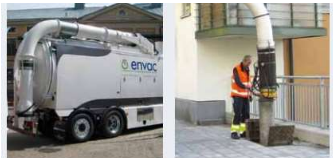
Slika 30: Prikaz mobilnega vakuumskega sistema (Vir: Envac head office, 2014)
