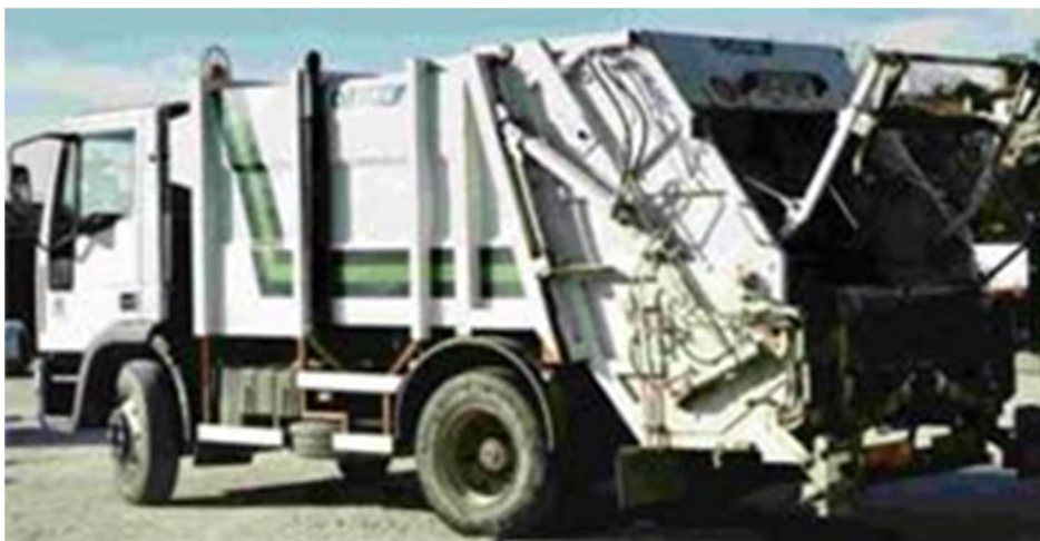
Slika 20: Smetarsko vozilo z avtostiskalnico – potisno ploščo (Vir: Ločevanje odpadkov)
