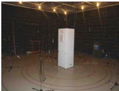
Slika 25: Hladilno-zamrzovalni aparat, pripravljen za meritev zvočne moči (Vir: Lasten)
