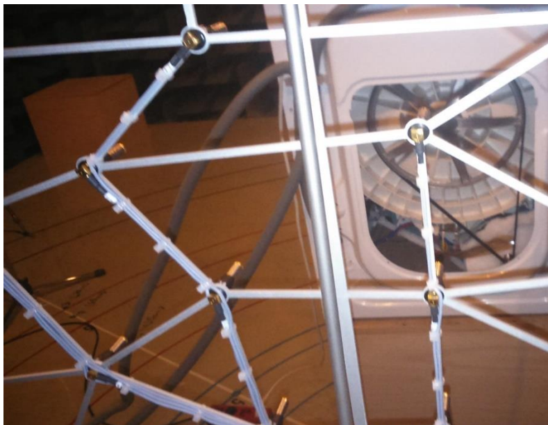
Slika 32: Meritev zvočne intenzivnosti z akustično holografijo na PS, izoliran motor PS (Vir: Lasten)
