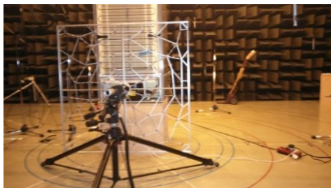
Slika 15: Meritev kompresorske enote hladilnika z akustično holografijo (Vir: Lasten)
