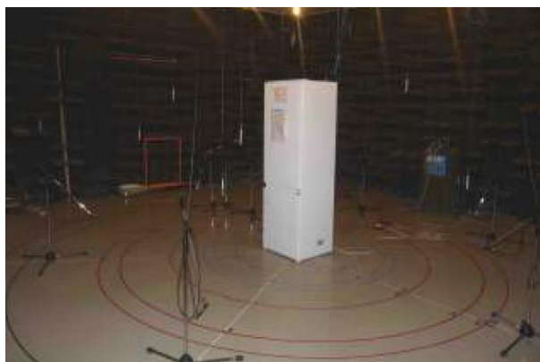
Slika 16: Pripravljen HZA v polgluhi sobi na meritve po absolutni metodi določanja zvočne moči (Vir: Lasten)
