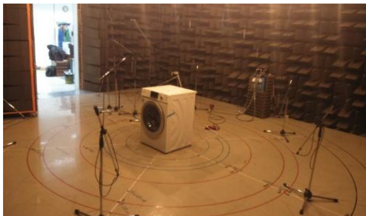
Slika 13: Mikrofoni razporejeni po ovojnici polkrogle v pol gluhi sobi (Vir: Lasten)
