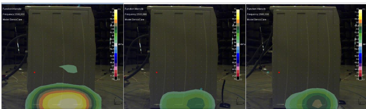
Slika 44: Zvočna slika akustične holografije 2.500 Hz (Vir: Lasten)
