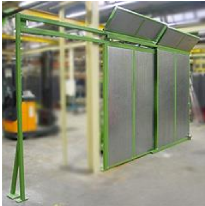
Slika 6.4: Postavitev panelov, ki se fiksirajo v tla z dodanim naklonskim absorberjem Vir: medmrežje http://www.bequiet.com/en/accessories/62 , 2014
