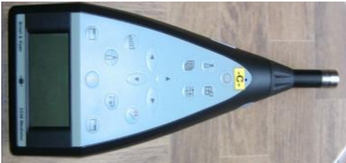
Slika A1: Inštrument za merjenje hrupa Brüel & Kjær, tip 2238 Mediator Vir: Tadič, 2014
