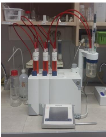
Slika 26: Naprava za merjenje pH-potenciometrične titracije, Avtomatski titrator:T70 , Mettler Toledo, ZDA
