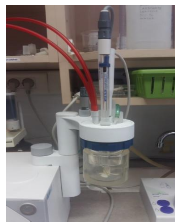
Slika 26: Naprava za merjenje pH-potenciometrične titracije, Avtomatski titrator:T70 , Mettler Toledo, ZDA
