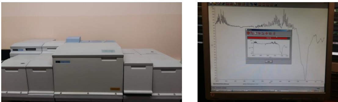
Slika 24: Prikaz aparature za meritve FTIR, Spectrum GX (Perkin Elmer)
