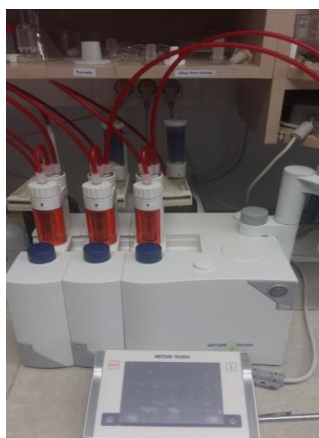
Slika 26: Naprava za merjenje pH-potenciometrične titracije, Avtomatski titrator:T70 , Mettler Toledo, ZDA
