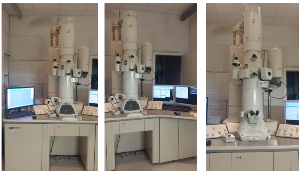
Slika 22: Prikaz presevnega elektronskega mikroskopa (TEM), Jeol JEM-2100 (Jeol)
