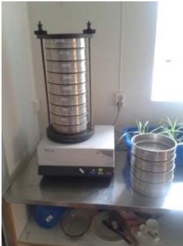
Slika 7: Tresalnik s siti v laboratoriju (Blaestad)
