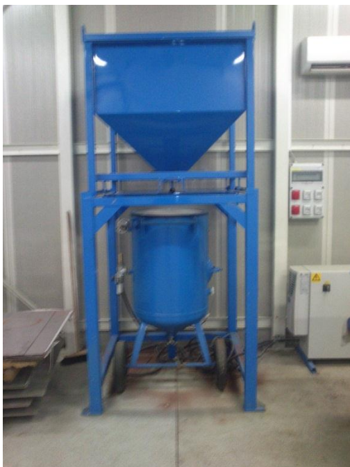
Slika 2: Na sliki je prikazan dozator za abrazivno sredstvo (Vir: Avtor, 2015)
