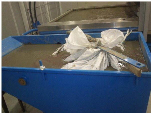
Slika 3: Filter za ločevanje abrazivnega sredstva od vode (Vir: Avtor, 2015)
