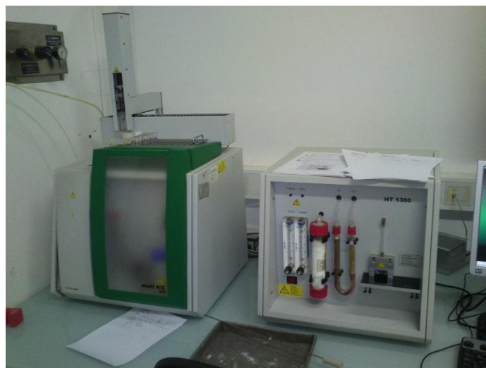
Slika 16: Na sliki je prikazan analizator za določitev DOC v tekočih vzorcih (levo), in analizator za določitev TOC v trdnih vzorcih (desno) (Vir: Avtor, 2015)
