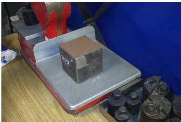
Slika 7: Določitev nasipne teže vzorca (Vir: Avtor, 2015)
