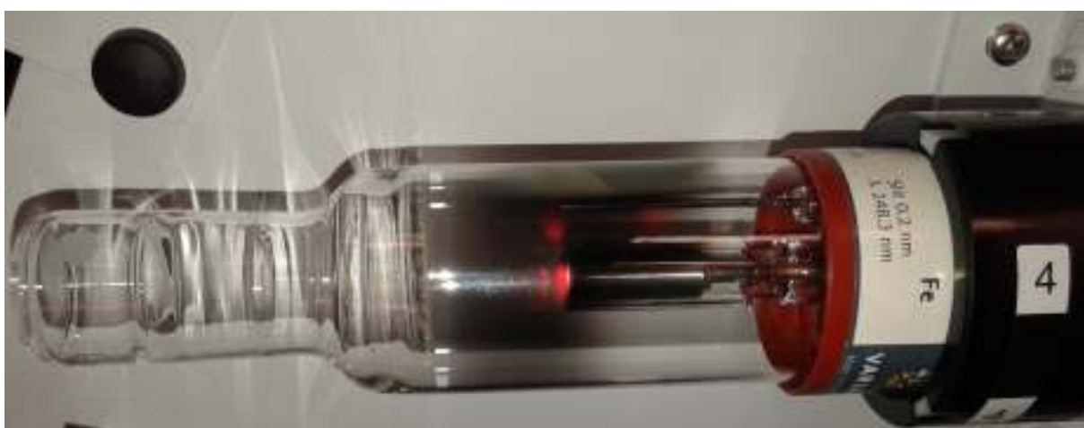
Slika 10: Žarnica, z votlo katodo, za železo; foto: J. Trbojević, 2015
