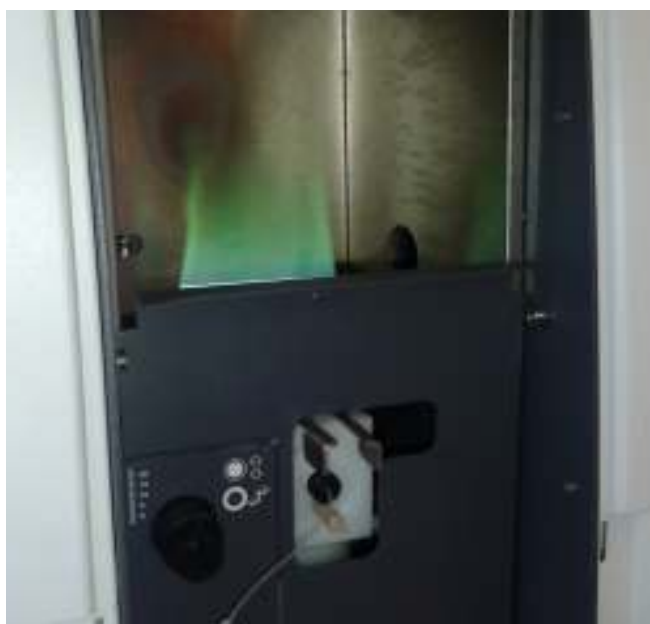
Slika 16: Merjenje raztopin vzorcev (raztopina vzorca \text{CuSO}_4 \times 5\text{H}_2\text{O} , z dodatkom standardne raztopine železa, razpršena v plamenu; foto: J. Trbojević, 2015
