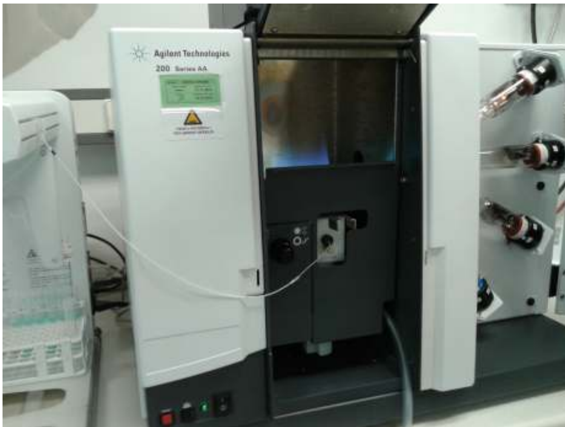
Slika 3: Pot raztopine vzorca od avtomatskega vzorčevalnika do plamena; foto: J. Trbojević, 2015
