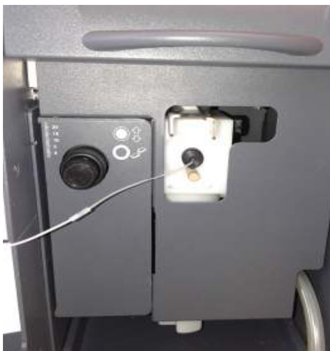
Slika 4: Razpršilna komora; foto: J. Trbojević, 2015
