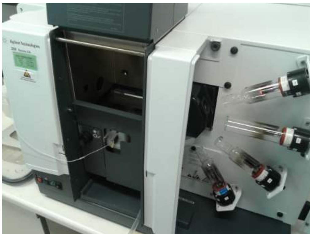
Slika 8: Prostor kamor postavimo žarnico; foto: J. Trbojević, 2015
