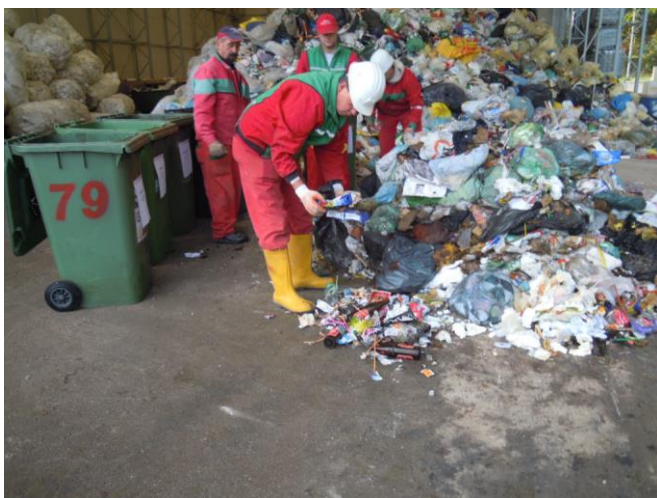
Slika 7: Izvajanje sortirne analize mešanih komunalnih odpadkov (Vir: PUP-Saubermacher)
