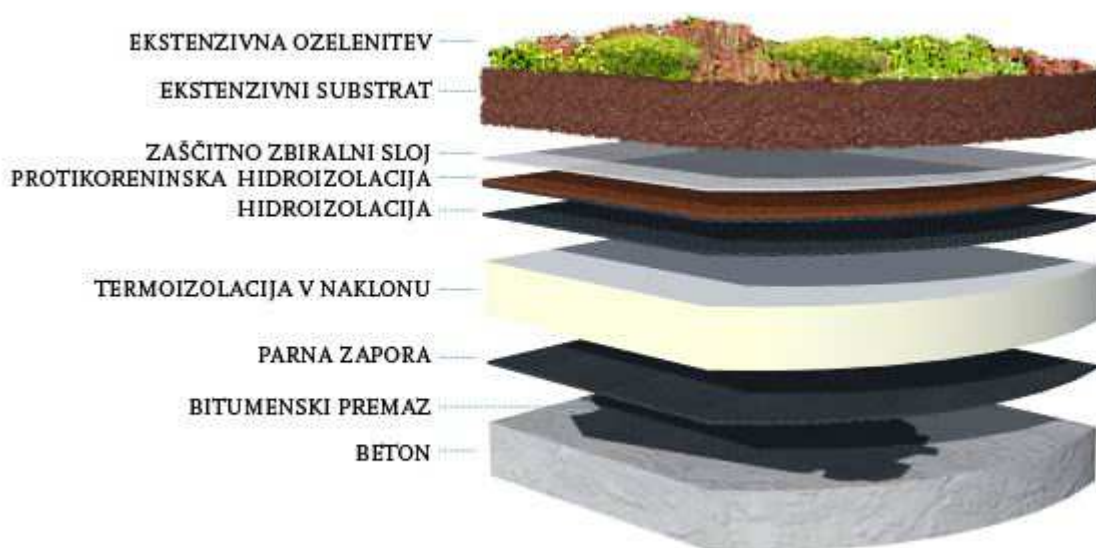
Slika 11: Prerez tople, intenzivno ozelenjene ravne strehe (Vir: medmrežje 10)
