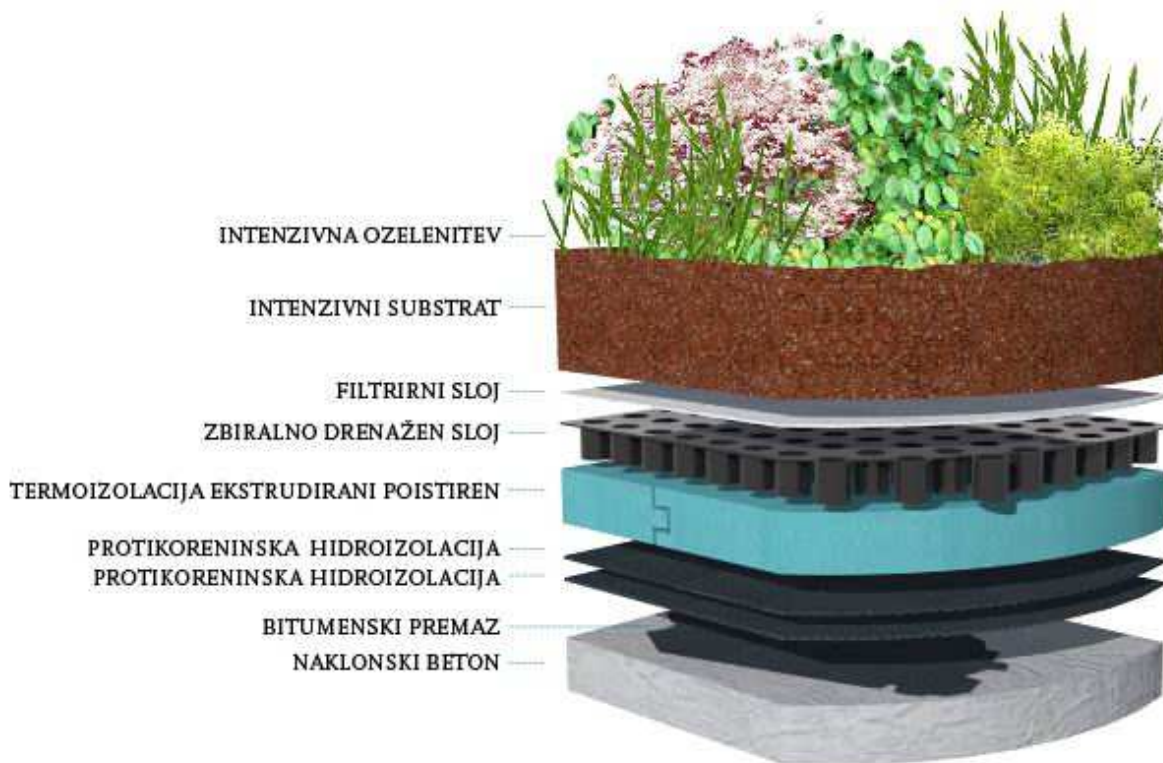
Slika 13: Prerez obrnjene, ekstenzivno ozelenjene ravne strehe (Vir: medmrežje 10)
