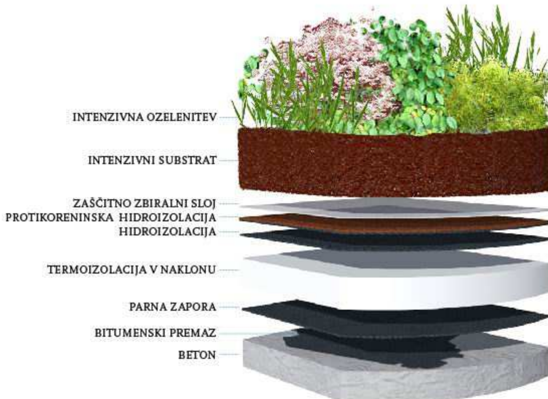
Slika 10: Prerez tople, ekstenzivno ozelenjene ravne strehe (Vir: medmrežje 10)
