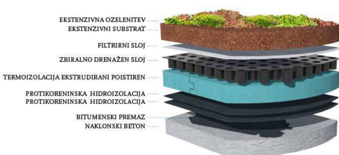
Slika 12: Prerez obrnjene, intenzivno ozelenjene ravne strehe (Vir: medmrežje 10)
