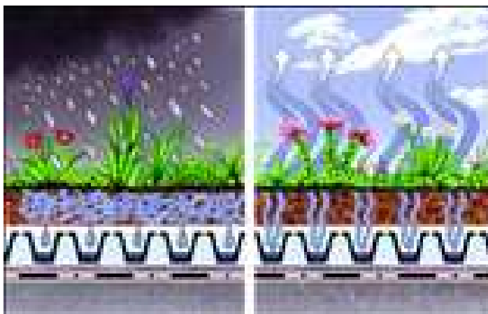
Slika 28: Prikaz zadrževanja in čiščenja deževnice (Vir: medmrežje 4)
