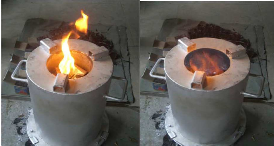
Slika 18: Prikaz gorenja v Anilovi peči: prva stopnja gorenja (levo) in druga stopnja gorenja (desno) z zgorevanjem lesnih plinov
