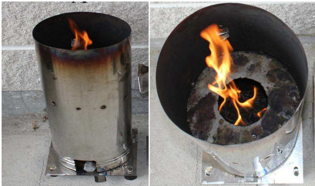
Slika 16: Primer TLUD kuhalnika, ki nima prisilnega vpihovanja zraka Elsa
