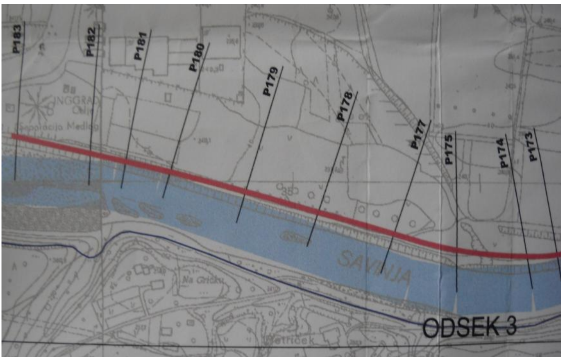
Slika 35: Prikaz situacije predvidene izgradnje protipoplavne zaš ite na obmo ju Špice ob sprehajalni poti med prerezoma P161 in P183 (Vir: Zagotavljanje poplavne varnosti ob Savinji na obmo ju MOC 2009).
