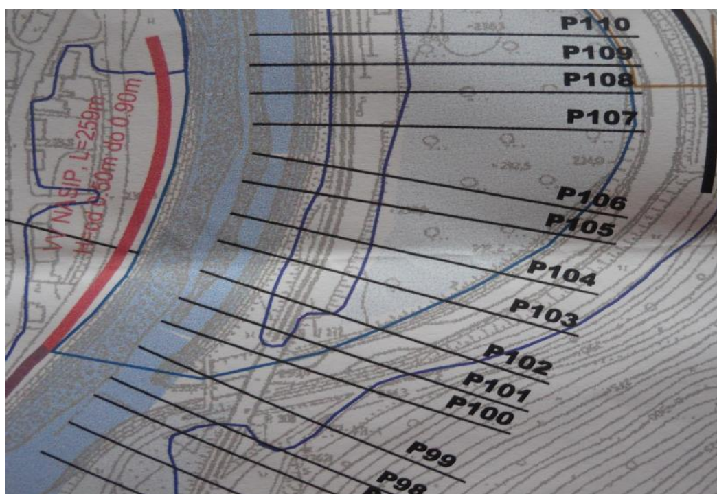
Slika 24: Prikaz situacije zagotavljanje poplavne varnosti na reki Savinji med prerezoma P98 in P110 (Vir: Zagotavljanje poplavne varnosti ob Savinji na območju MOC 2009).
