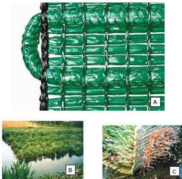
Slika 21: Nosilni medij iz polivinila v čistilnem bazenu in njegova prerast s koreninami, (Vir: Headley in Tanner, 2006)
