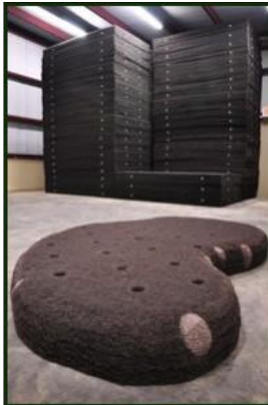
Slika 23: Primer nosilnega medija iz poliestra (nosilni medij) in polistirena (omogoča plovnost), (Vir: Medmrežje 10)
