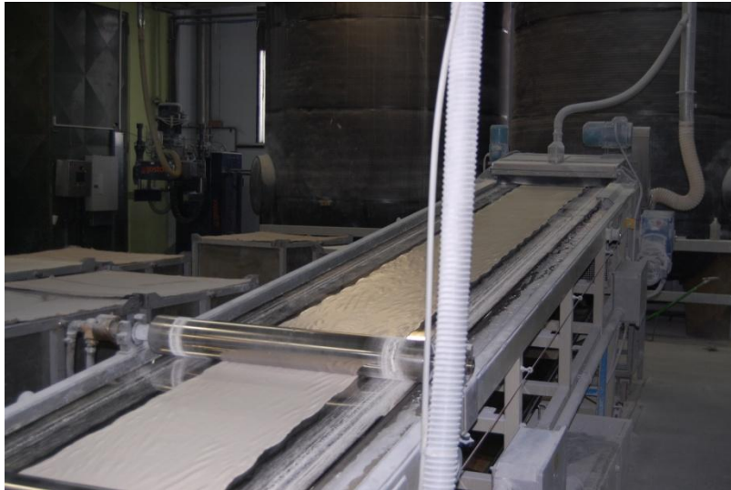
Slika 7: Valjanje in ohlajevanje ekstrudata Vir: lasten
