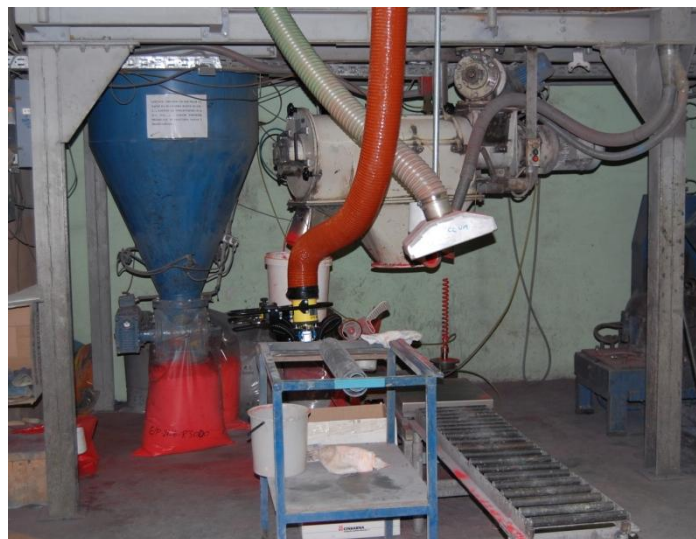
Slika 8: Mletje in pakiranje praškastih lakov Vir: lasten
